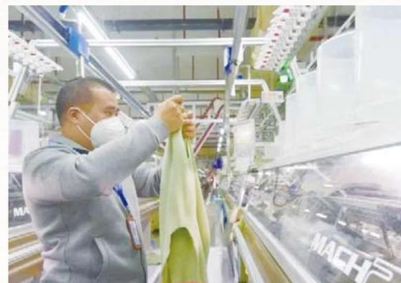
在福建泉州南安市南益电脑针织有限公司生产车间内，佩戴口罩的工人们正在来回巡视着自动化生产线上的生产状况。南益电脑针织配备近1000台电脑横机，生产区还包括14条缝挑吊挂生产线、7条后整吊挂生产线，并以自动输送系统连接电机、缝挑、洗水和后整包装三大系统，实现了几大流程的不落地生产。
