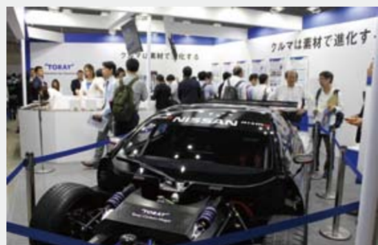
“NISMO”的副车架等采用CFRP制成（东丽）。
