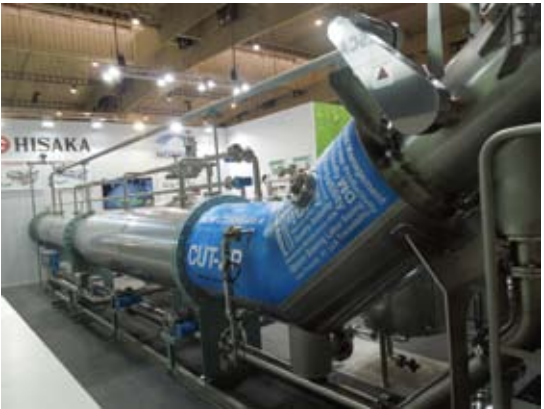
日阪制作所公司的液流染色机“CIRCULAR CUT-ZR”。
