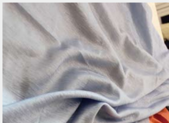
坪由织物 ：用Lenzing公司的Lyocell长纤维“Tencel Luxe”交编、交织，实现超越丝绸光泽感的特里科经编面料、梭织面料。
